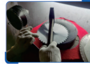
5、STEEL PLATE LEVELING
